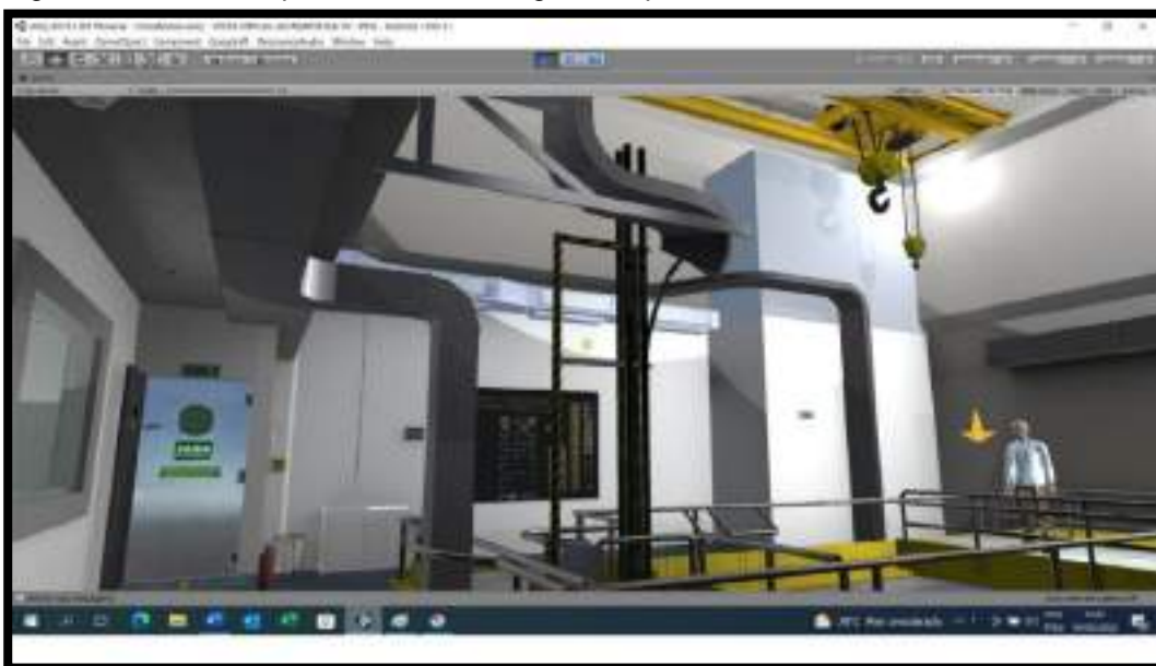
Figura 55 – Visão da ponte rolante do saguão da piscina do reator IEA-R1
