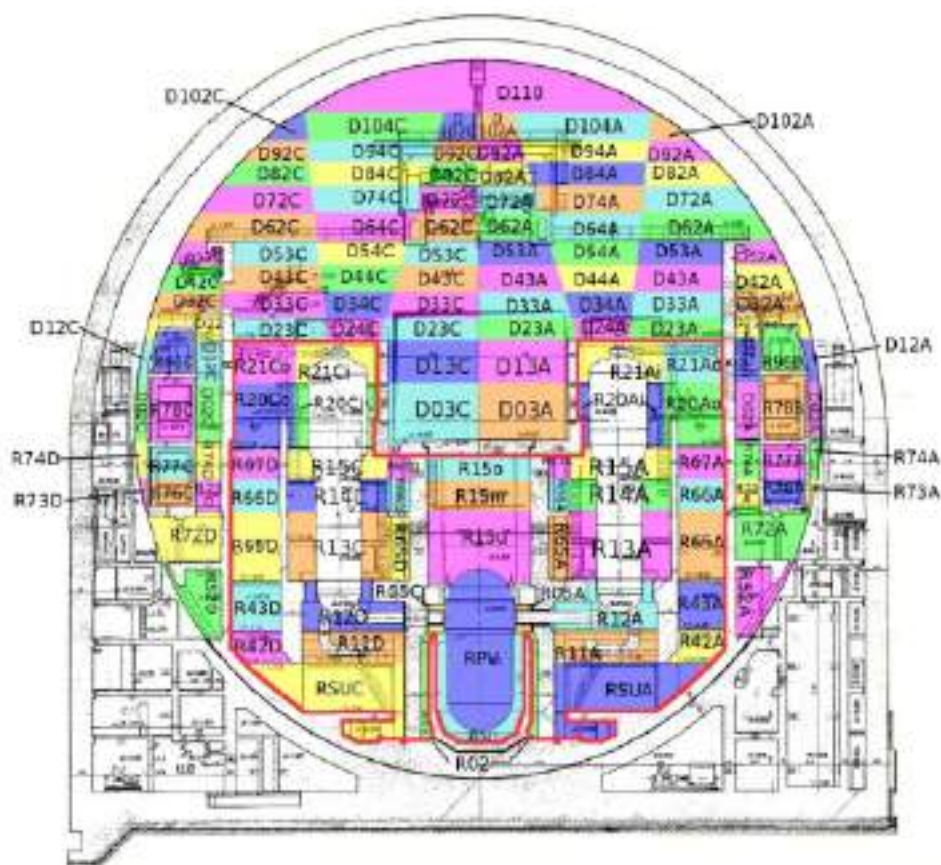
Figura 3.5: Nodalização da contenção do reator Konvoi-PWR com o COCOSYS V2.4 /41/
