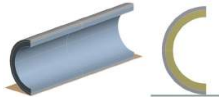
Figura 3.2 – Modelos - 3D com dois planos de simetria (esquerda) e 2D Plane Strain (direita)
