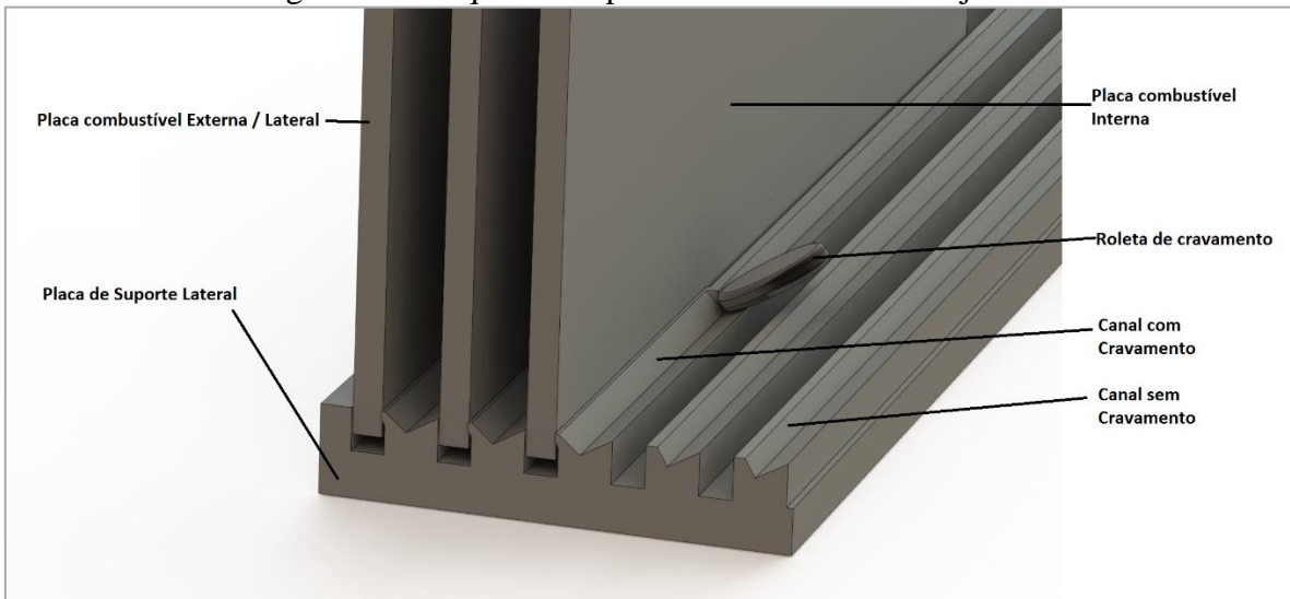
Figura 15 – Esquema da placa combustível no conjunto
