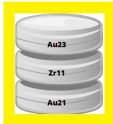
Figura 23 - Disposição geométrica dos monitores com uma espuma amarela (multiuso) em volta, dentro do recipiente (coelho) de irradiação.
