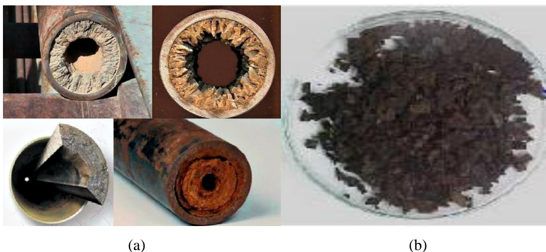
Figura 1 - Tubulações de água com incrustações internas (a) e amostra de borra de petróleo seca (b).
