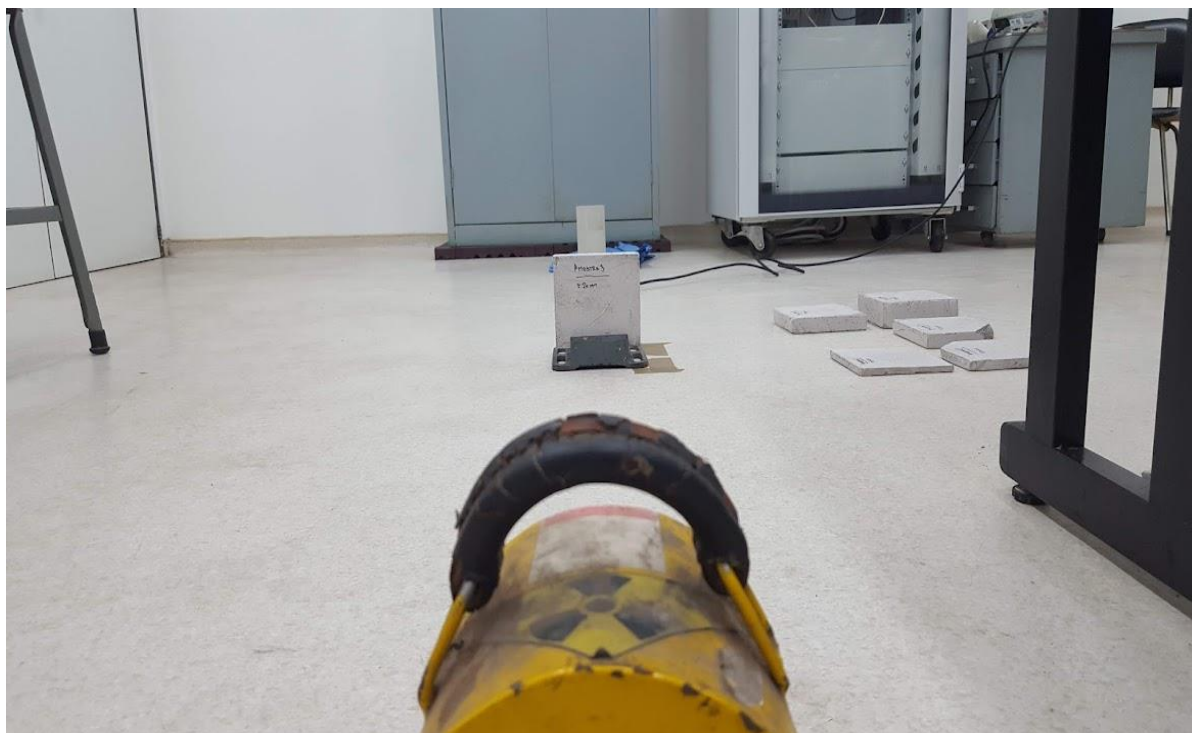
Foto 13 – Aparato experimental para as leituras de atenuação – detalhe
