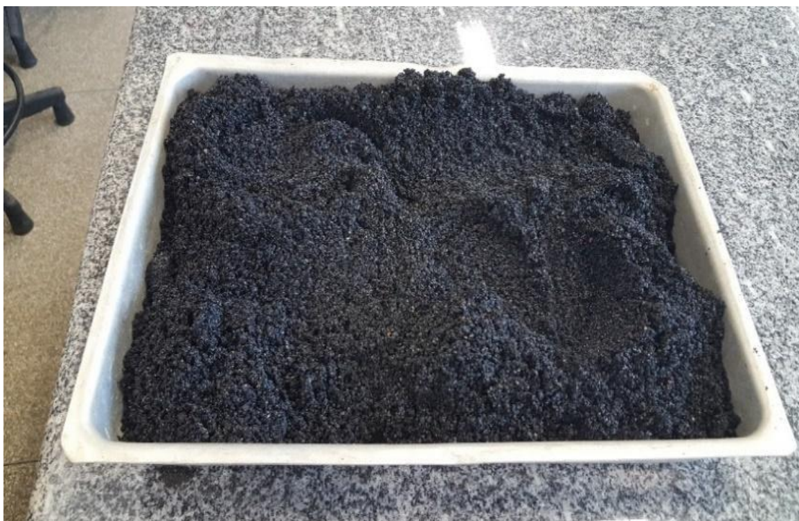
Foto 3 – Amostra da escória reduzida no laboratório
