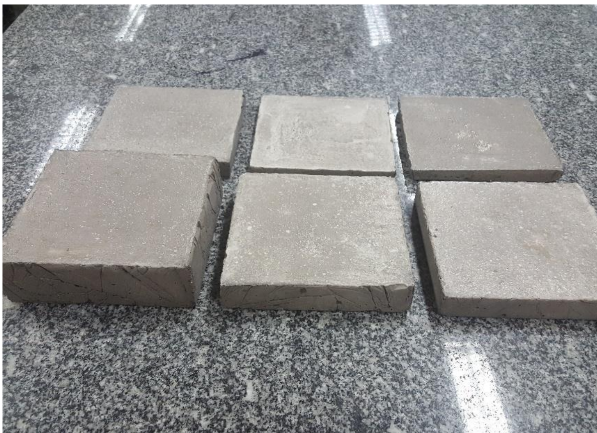
Foto 9 – Corpos de prova da argamassa produzida com agregado miúdo de escória da metalurgia da cassiterita
