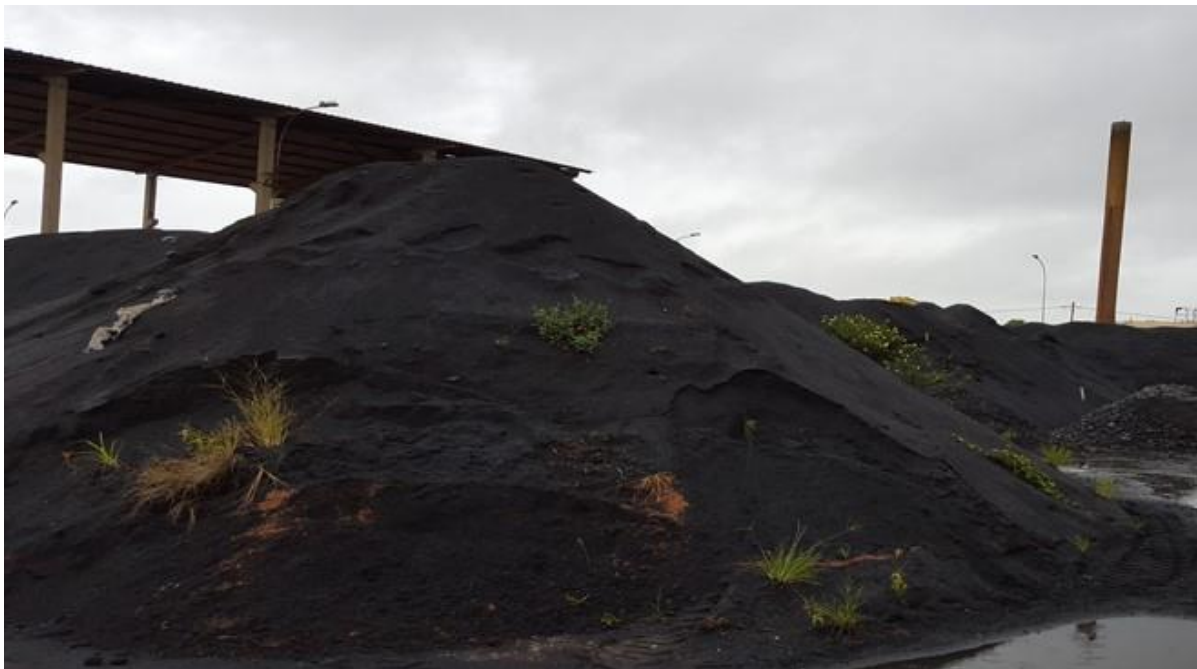
Foto 1 –Escória da metalurgia da cassiterita depositada a céu aberto
