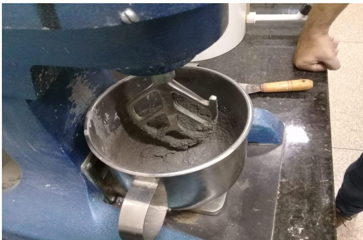
Foto 6 – Confeção dos traços de argamassa com agregado miúdo da escória da metalurgia da cassiterita
