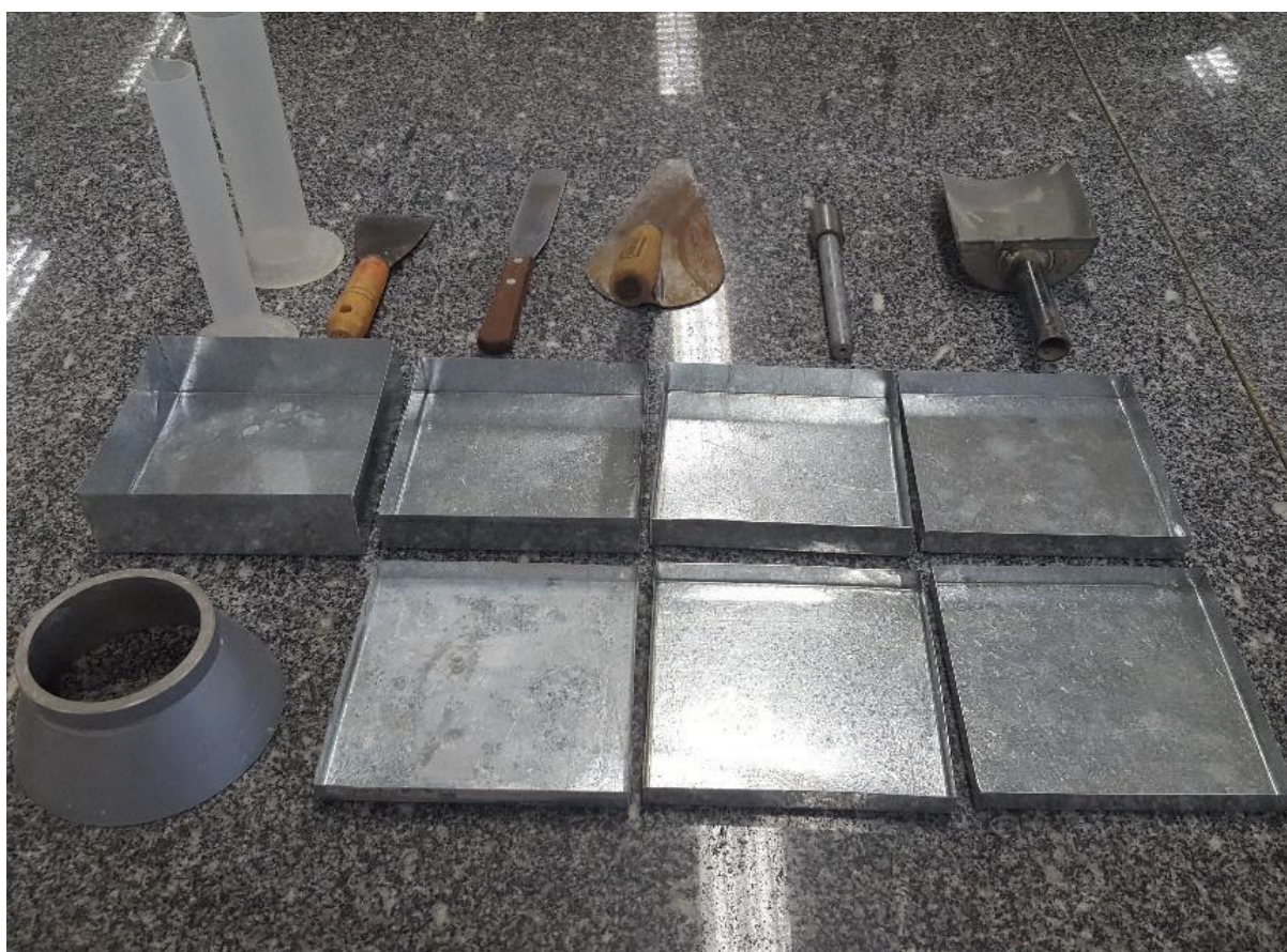
Foto 8 – Moldagem dos corpos de prova da argamassa
