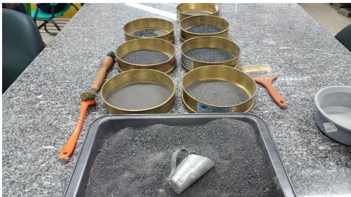
Foto 4 – Ensaio de granulometria
