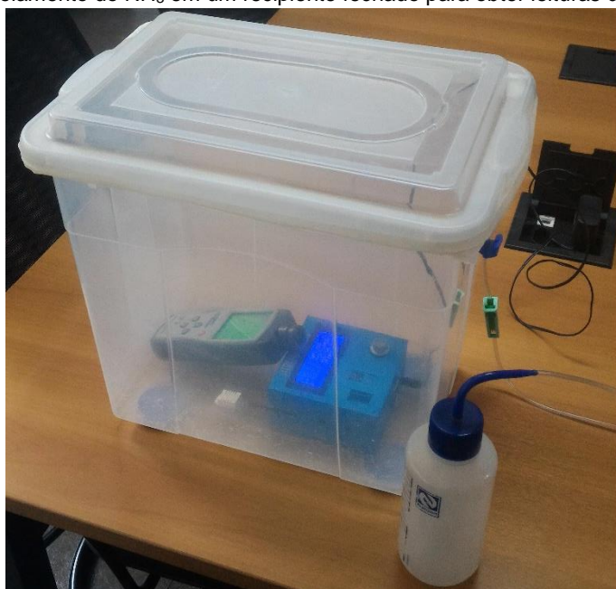
Figura 29 - Isolamento do NH 3 em um recipiente fechado para obter leituras do AR8500 e do MQ137.
