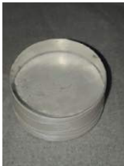
Figura 4.2 - Cristal de CsI:Li revestido com fita de teflon
