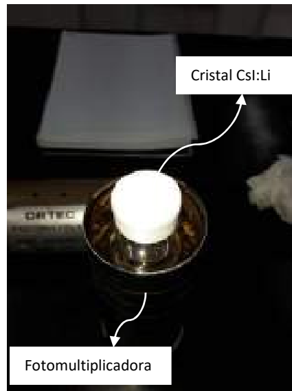
Figura 4.3 - Montagem do cristal acoplado com a fotomultiplicadora com graxa de silicone Dow Corning
