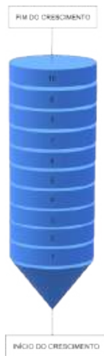
Figura 4.1 - Esquema de corte do cristal CsI:Li 10^{-3} M
