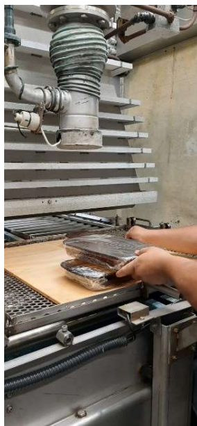
Figura 5 : Feixe de elétrons para o pré-tratamento
