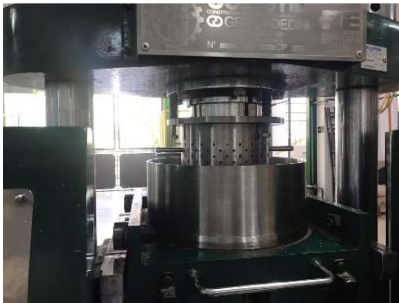
Figura 2: Extração do caldo utilizando a prensa hidráulica
