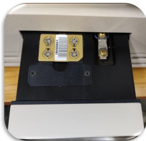
Figura 13 - Compartimento da leitora TL Harshaw 4500 com espaço para o cartão dosimétrico preenchido
