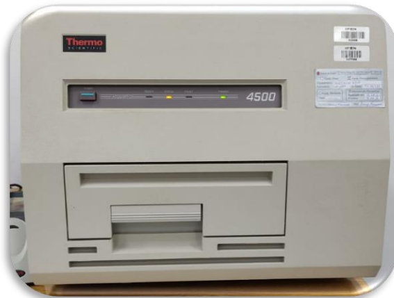
Figura 11 - Leitora termoluminescente da marca Harshaw modelo 4500
