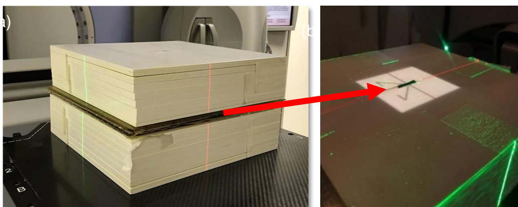
Figura 24 - (a) Simulador com placas de bolus gel no centro, abaixo das quais (b) está posicionada a amostra de filme OSLD.
