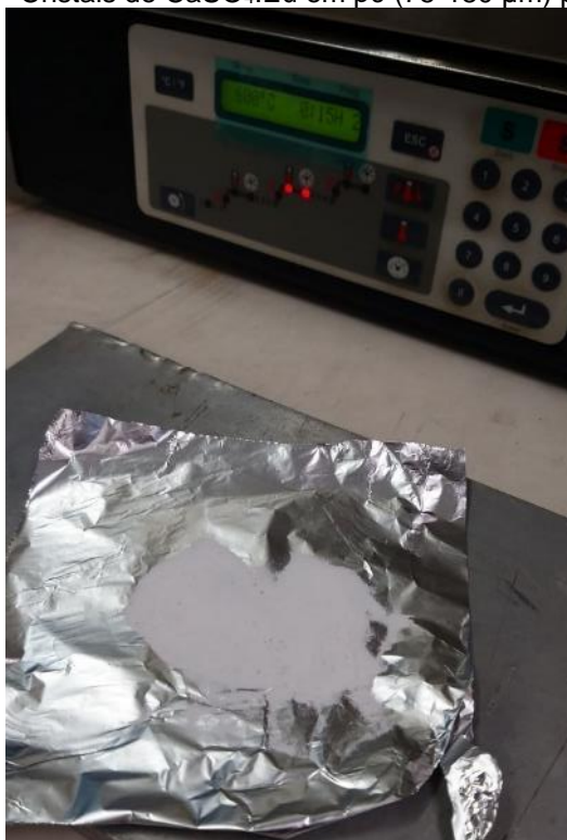
Figura 15 - Cristais de \text{CaSO}_4:\text{Eu} em pó (75-180 \mu\text{m} ) produzidos.
