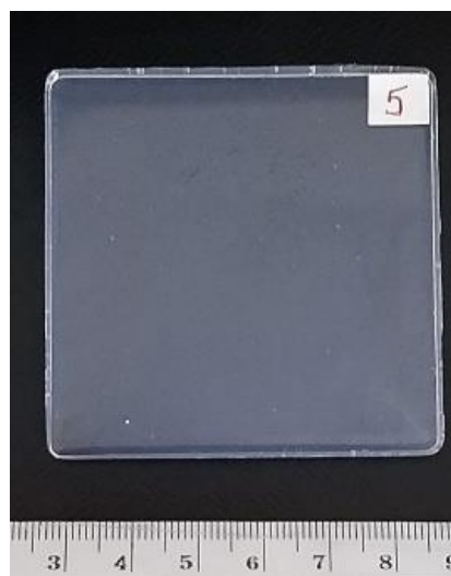
Figura 42 - Amostra de filme puro, após cura, produzida com material A, no qual foi passado o rolo fura-bolhas antes da cura.
