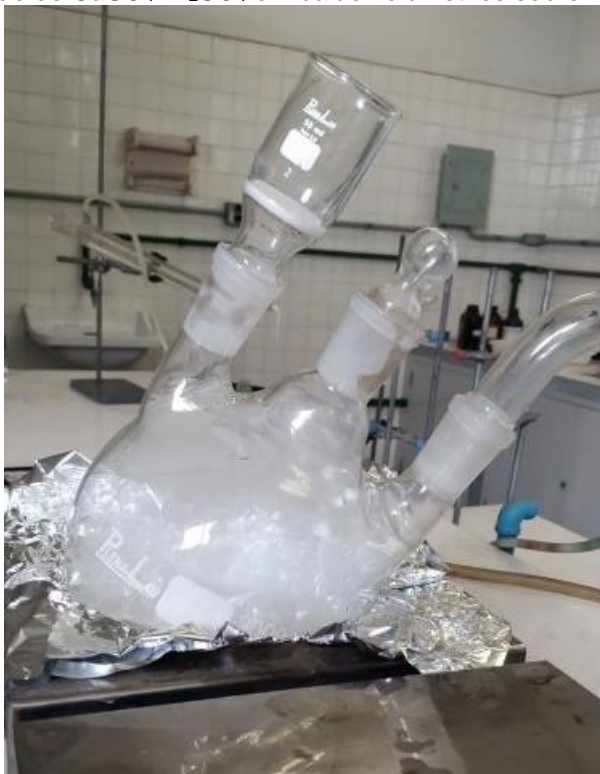
Figura 12 - Solução de \text{CaSO}_4 + \text{H}_2\text{SO}_4 em balão volumétrico sobre manta aquecedora.
