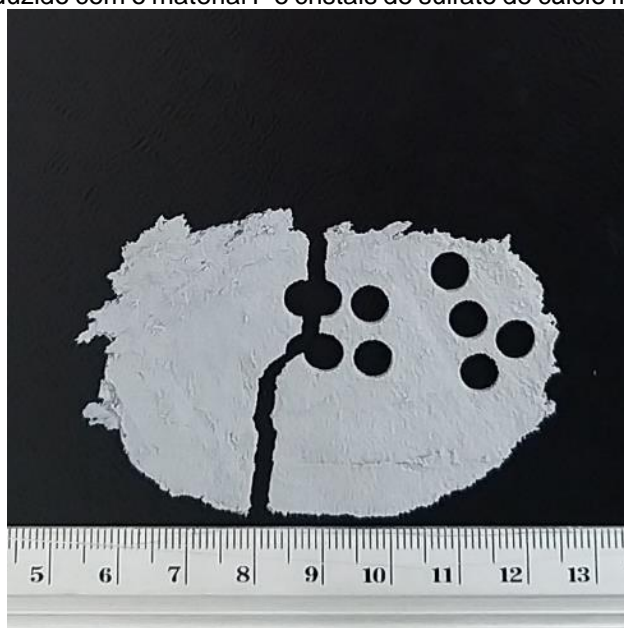
Figura 37 - O filme produzido com o material F e cristais de sulfato de cálcio ficou rígido e quebradiço.
