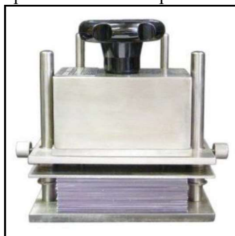
Figura 17 - Modelo de Perspirômetro utilizado para ensaios de solidez da cor à água
