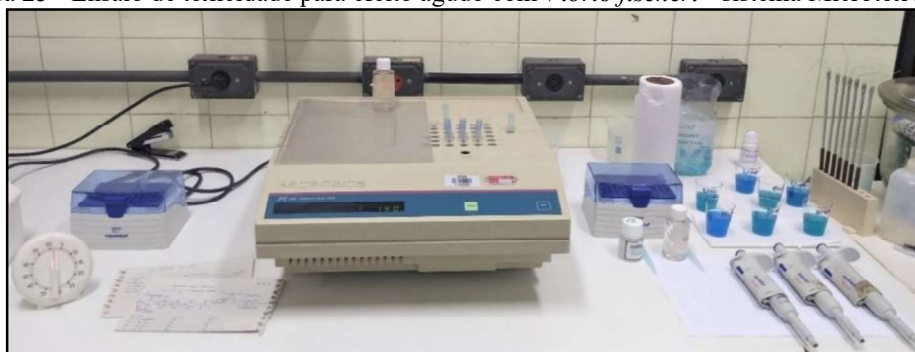
Figura 25 - Ensaio de toxicidade para efeito agudo com Vibrio fischeri - sistema Microtox M-500
