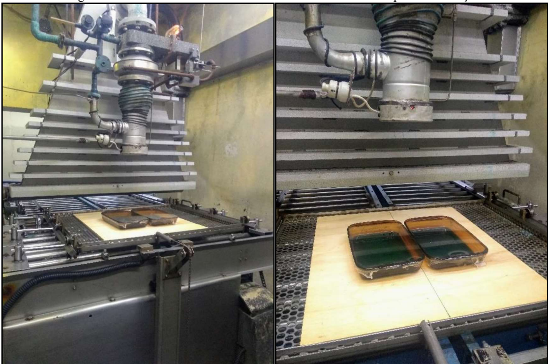
Figura 23 - Acelerador de elétrons Modelo JOB 188 utilizado para a irradiação
