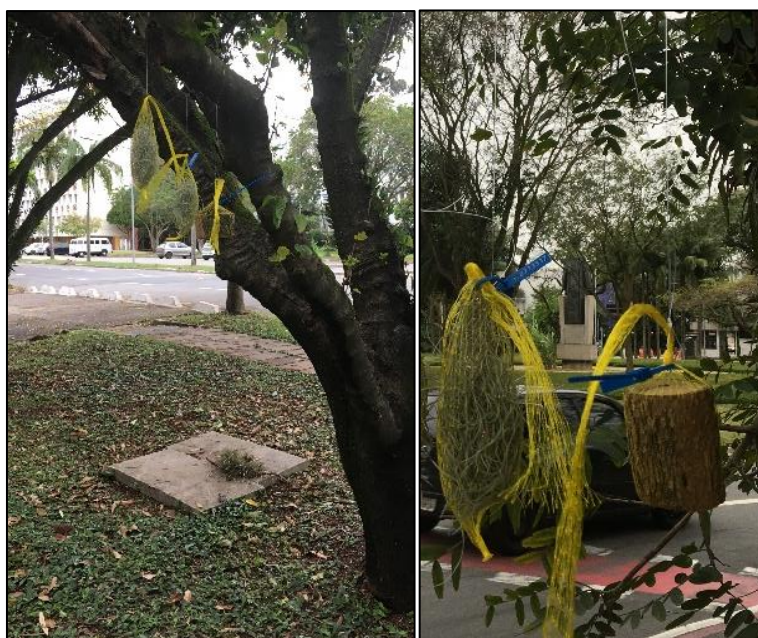
Figura 10 – Fotos das amostras de T. usneoides e de corpo de prova de casca de T. tipu em embalagens de redes plásticas expostas no biomonitoramento ativo
