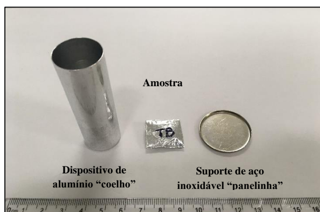
Figura 12 – Foto do dispositivo “coelho” de alumínio, da amostra embrulhada em folha de alumínio e do suporte de aço inoxidável utilizados na irradiação de longa duração
