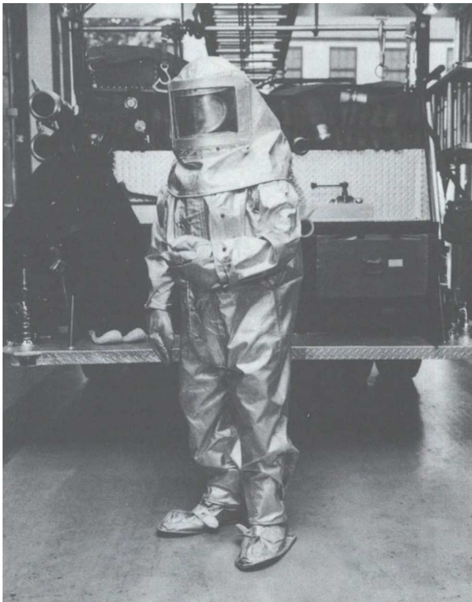
Figura 5 – VPR modelo B12 para trabalho com raios X e raios gama de energia pequena [1].
