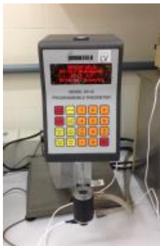
FIGURA 21 – Viscosímetro Brookfield, modelo DV-III, utilizado para o estudo reológico da mucilagem de chia
