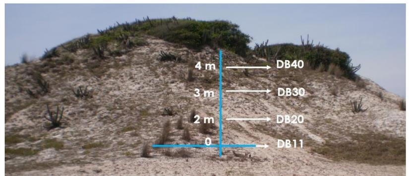
**Figura 9.4** – Vista lateral e indicação da colocação dos tubos para retirada de sedimento.
