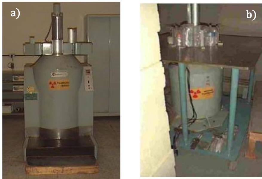
**Figura 9.9** – Sistemas de irradiação do CTR: a) Gamma Cell e b) Panorâmica
