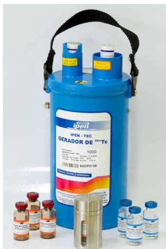
Figura 9: Gerador ^{99}\text{Mo} - ^{99\text{m}}\text{Tc} produzido no IPEN (IPEN-TEC®).
