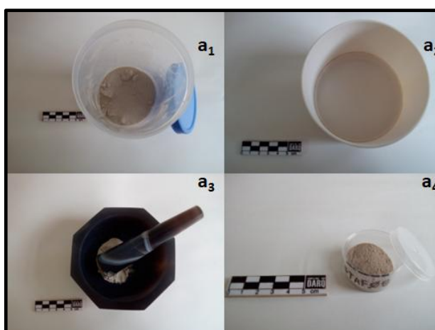
Figura 30 – Representação gráfica do preparo de amostra para análise por AANI. a1) amostra de sedimento, a2) peneira, a3) almofariz e pistilo de ágata e a4) amostra armazenada em potes de polietileno.
