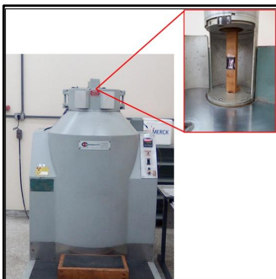
Figura 37 - Representação gráfica do irradiador GAMMACELL 220 da Atomic Energy of Canada Limited localizado no CETR IPEN/CNEN-SP.
