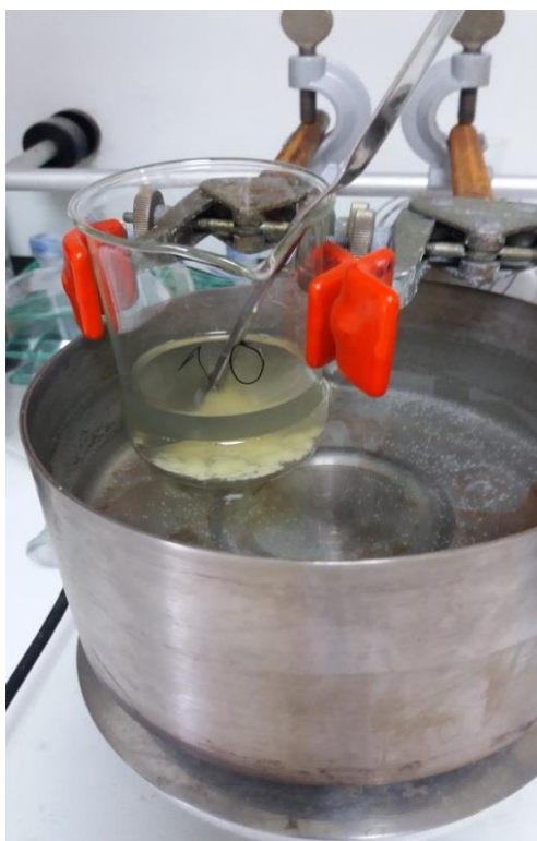
Figura 4 - Amostra de manteiga de cacau, em imersão em banho maria à 50° C.
