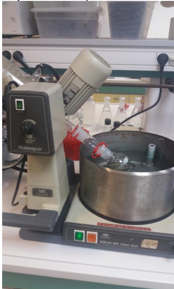
Figura 6 - Evaporação em rota evaporador a 40 °C em vácuo mínimo.
