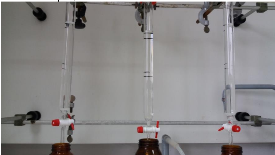
Figura 8 - Colunas de vidro de 21 cm, identificadas com dois conjuntos de dois tempos, sendo acondicionadas com hexano.
