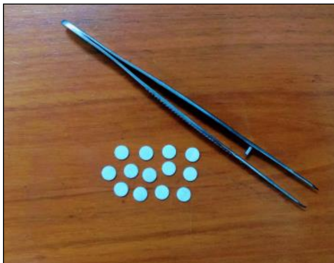
Figura 6 – Pastilhas dosimétricas de CaSO 4 :Dy
