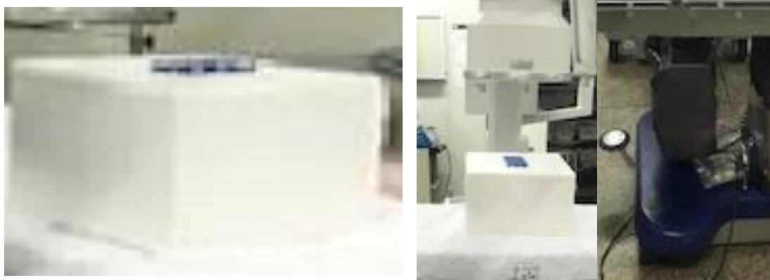
Figura 8 – Objeto simulador de poliestireno expandido - Isopor e posicionamento para irradiação
