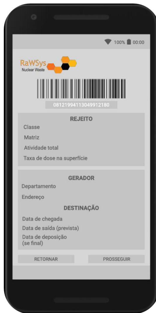
Figura 72: Interface da aplicação mobile. C) Tela de câmera para escaneamento de etiqueta. D) Tela com etiqueta de confirmação e dados após escaneamento.
