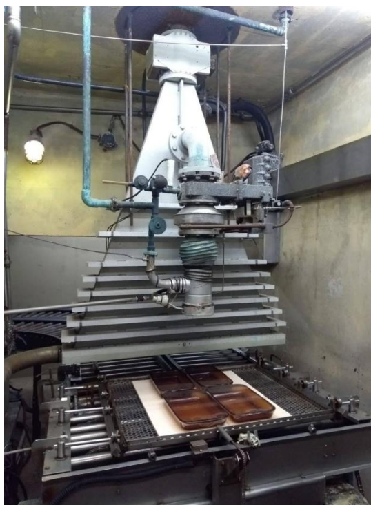
Figura 8 - Acelerador de Elétrons (CETER/IPEN) com amostras dos produtos farmacêuticos para a irradiação.
