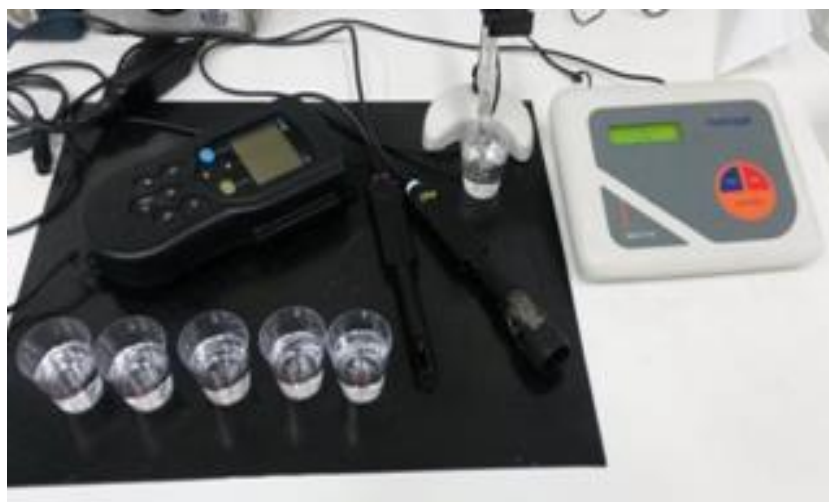
Figura 11 - Equipamentos utilizados para medir os valores de pH, oxigênio dissolvido e condutividade.
