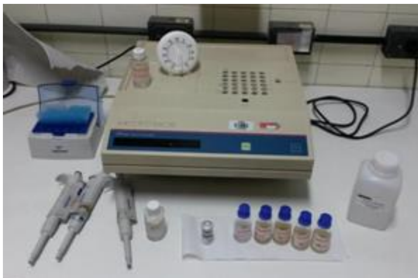
Figura 10 - Sistema Microtox®, ensaio com a bactéria V. fischeri .
