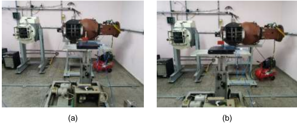
Figura 11: Arranjo para determinar a radiação espalhada
