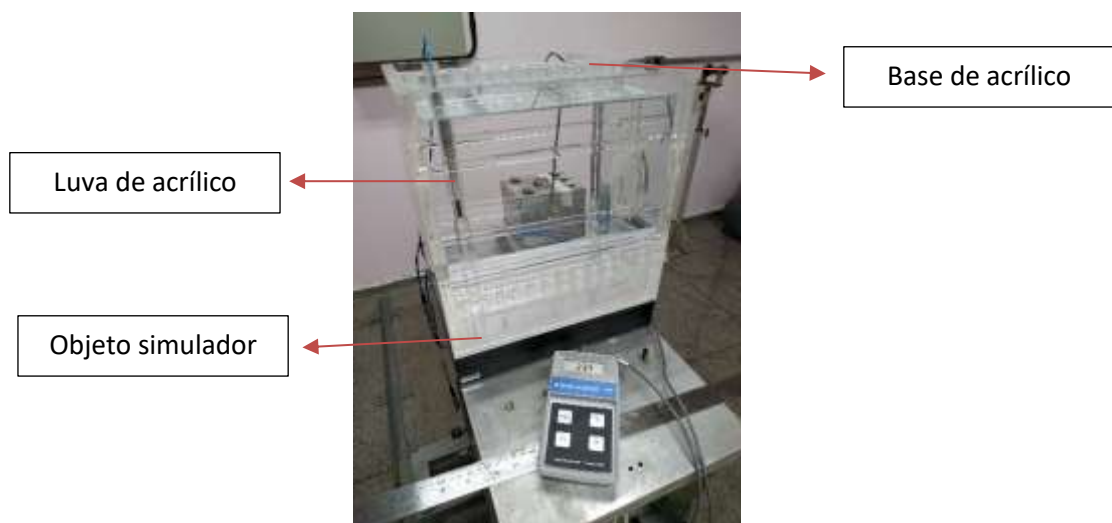
Figura 7: Arranjo utilizado para posicionar a câmara de ionização, composto pela base e a luva.
