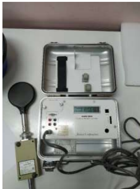
Figura 4: Monitor de área Radcal modelo 9015, utilizado na medição da fuga dos irradiadores
