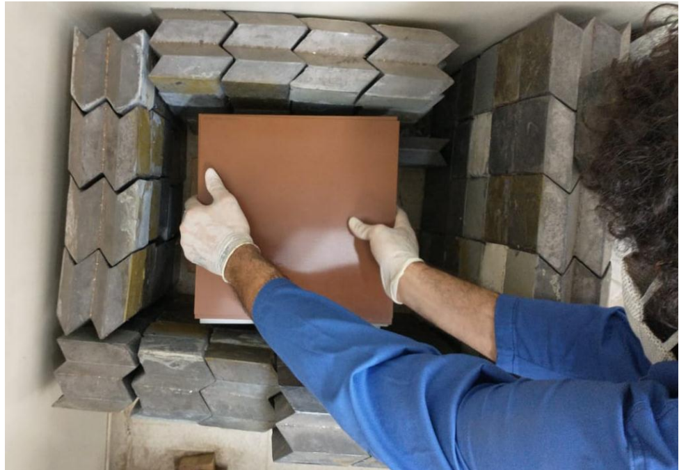
Figura 18 - Arranjo experimental - Colocação das Placas RW1 sobre Placa de ^{32}\text{P} + Filme Radiocrômico
