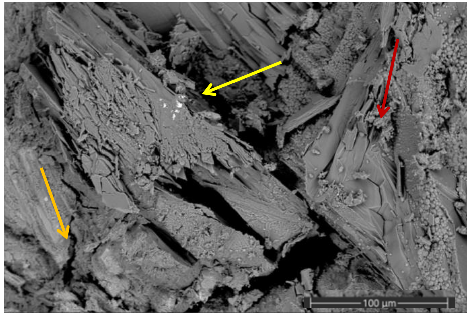
Figura 28: Espaço angular entre os grãos de plagiocásio, alteração do plagioclásio e microfraturas.
