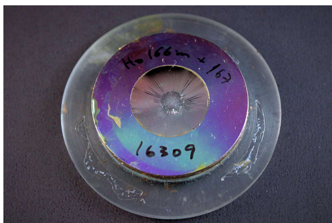
Figura 3.5 – Amostra de Ho em filme fino de collodion metalizado em Au, fixado em arandela de Al, sobre um suporte de polietileno.
