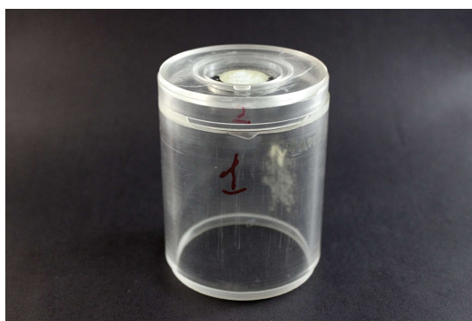
Figura 3.14 – Suporte utilizado nas medidas no HPGe para delimitar a distância entre a fonte e o detector.
