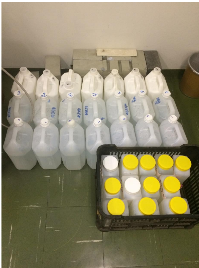
Figura 20 - Galões de água contendo as amostras acidificadas pré-concentração.
