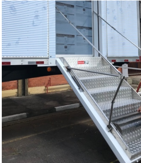
Figura 29. Porta aviônica com escadas incorporadas.
