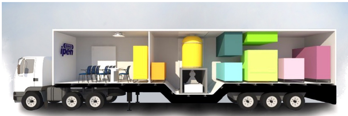
Figura 10. Estudo dos volumes - Imagem 3D com a distribuição dos equipamentos na unidade móvel de irradiação por feixe de elétrons.
