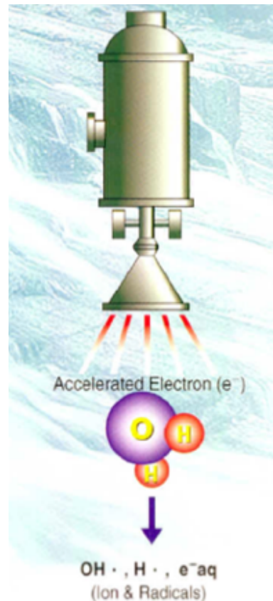
Figura 3. Sistema de tratamento de águas residuais por feixe de elétrons.
