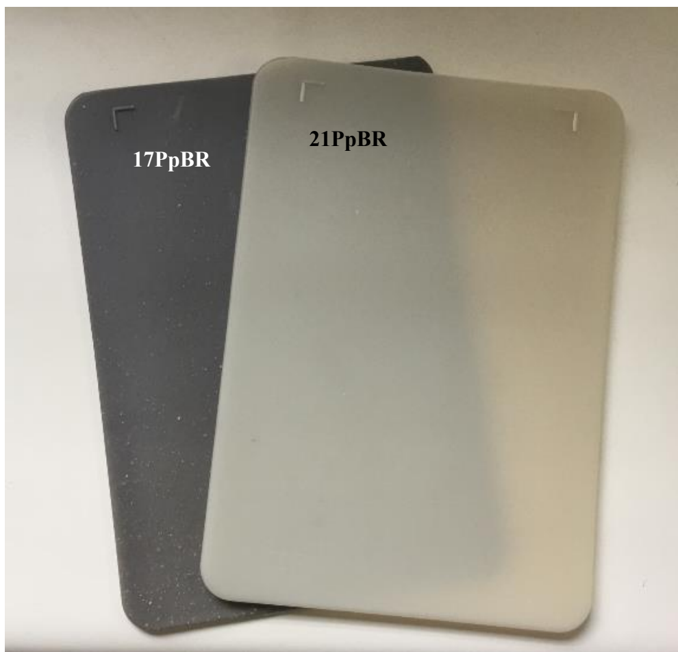
Figura 4-16 - Protótipos 17PpBR e 21PpBr produzidos com base de polipropileno e aditivos pelo processo industrial com moldagem por injeção.
