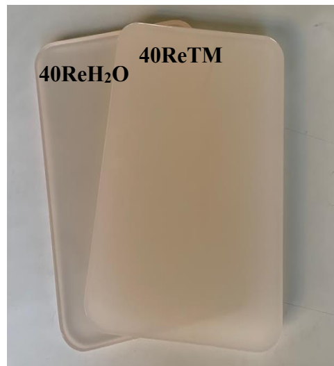
Figura A III-5 - Placas de material radiologicamente equivalente a tecido 40ReH 2 O refeita e 40ReTM.
