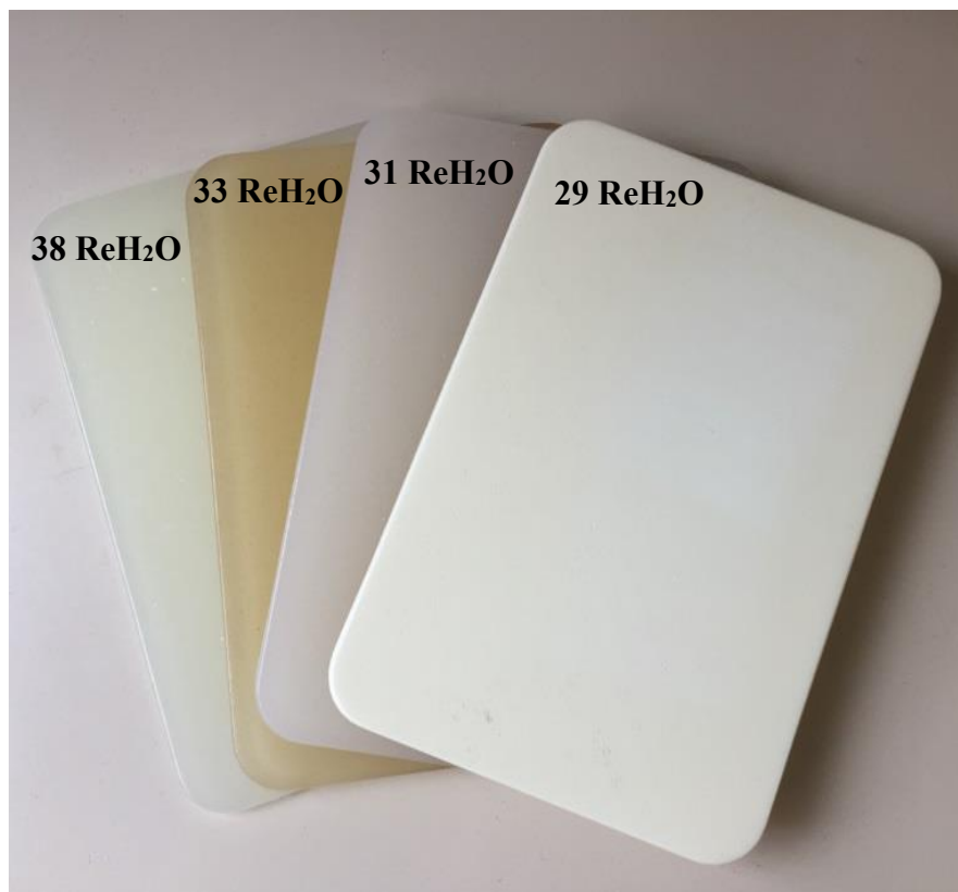
Figura 4-15 - Protótipos 29ReH 2 O, 31ReH 2 O, 33ReH 2 O e 38ReH 2 O produzidos aplicando o método de Mariano & Costa pelo processo laboratorial, utilizando resina epóxi.
