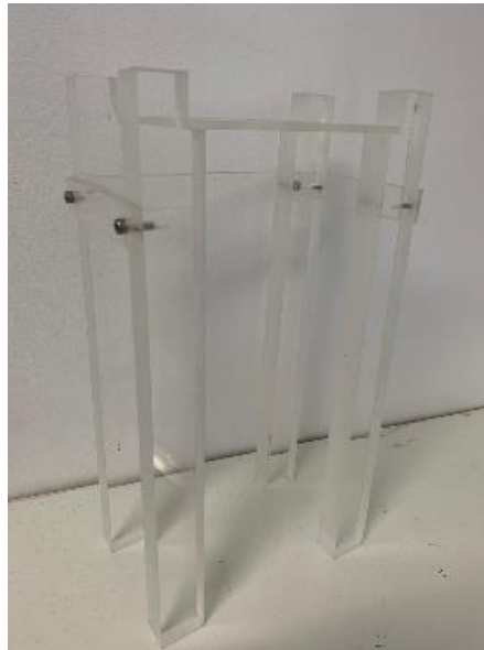
Figura 3-10 - Suporte de PMMA (polimetilmetacrilato) utilizado para posicionamento dos protótipos no arranjo experimental II.
