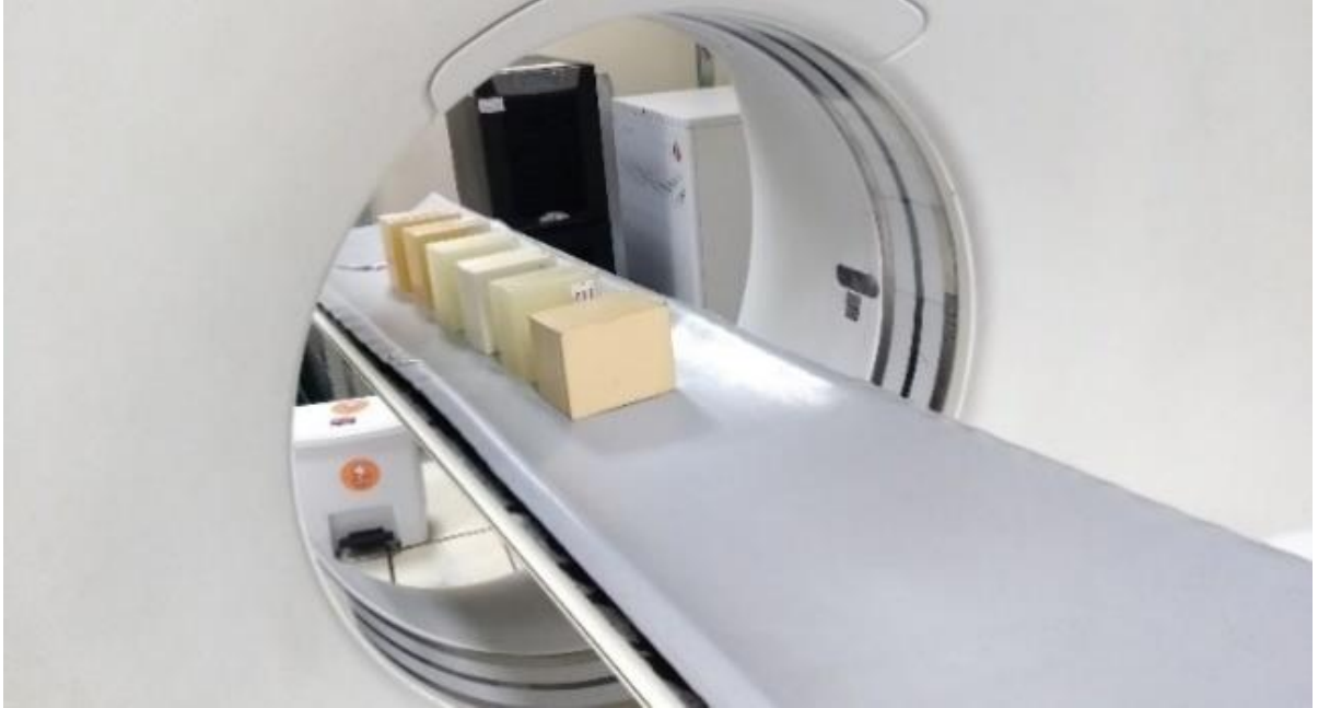
Figura 4-29 - Blocos de protótipos 29ReH 2 O, 31ReH 2 O, 33ReH 2 O e o 38ReH 2 O posicionados no suporte (identificados do fundo para frente na ordem citada respectivamente) de paciente de um equipamento de tomografia computadorizada de dupla energia.
