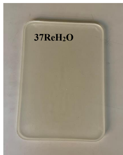
Figura A III-6 - Placa de material radiologicamente equivalente a tecido 37ReH 2 O.
