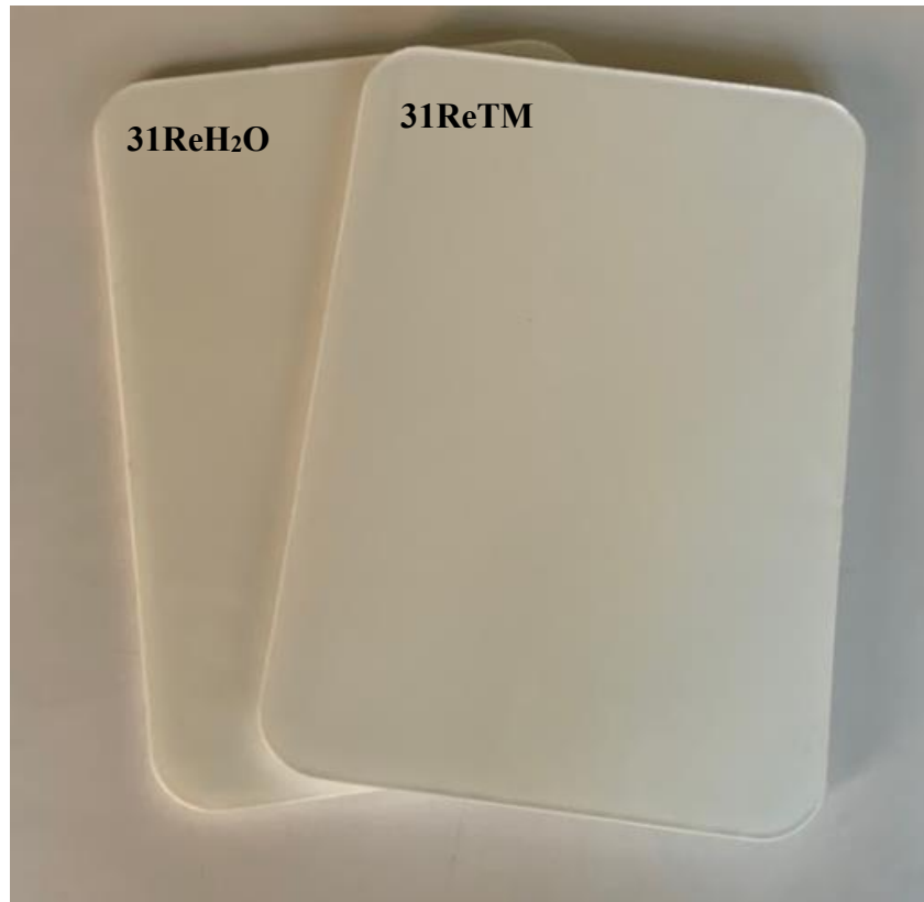
Figura A III-2 - Placas de material radiologicamente equivalente a tecido 31ReH 2 O refeita e 31ReTM.
