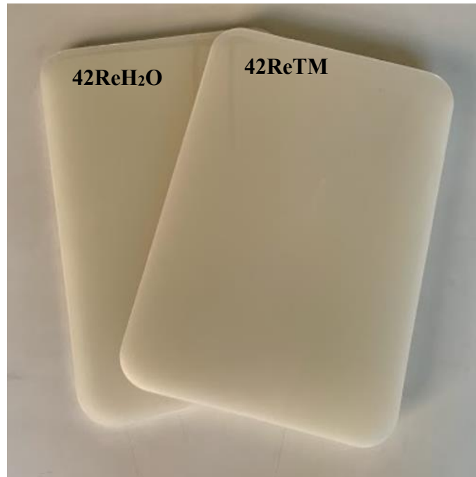
Figura A III-3 - Placas de material radiologicamente equivalente a tecido 42ReH 2 O e 42ReTM .
