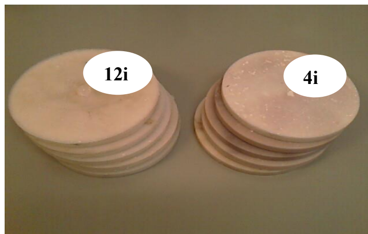
Figura 4-13 - Protótipos obtidos pelo processo industrial de extrusão à quente com 1cm de espessura e 12cm de diâmetro.
