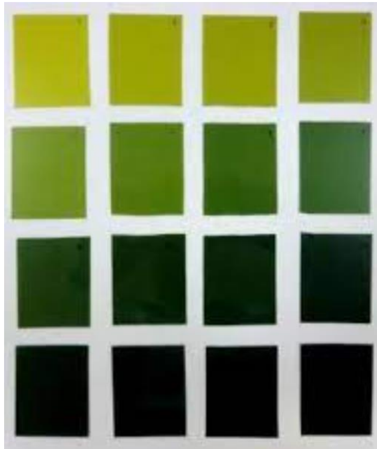
Figura 10 – Filmes radiocrômicos irradiados com aumento sucessivo de dose.
