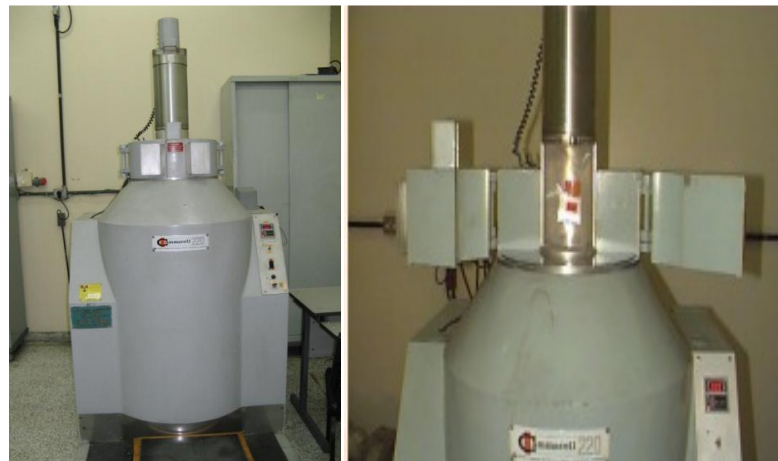
Figura 12: Fonte de ^{60}\text{Cobalto} - Gammacell 220 no SERD-IPEN-CNEN
