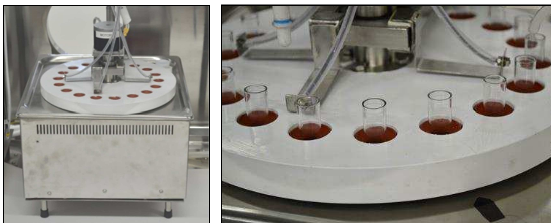
FIGURA 44: Imagem do suporte montado no banho de ultrassom (a) e imagem dos tubos inseridos no suporte (b).
