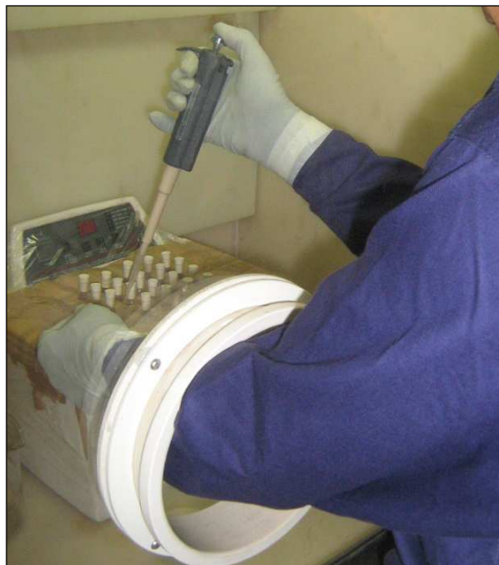
FIGURA 8: Realização manual de ensaios de estanqueidade no interior de capela com exaustão.
