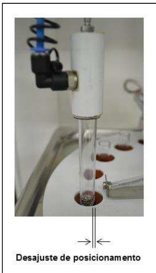
FIGURA 82: Desajuste no posicionamento do tubo.
