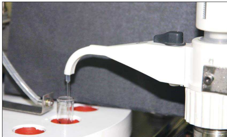
FIGURA 57: Imagem do dispositivo executando o enchimento de um tubo.
