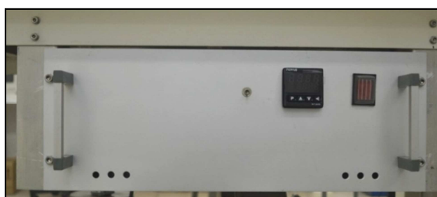
FIGURA 38: Gabinete elétrico do banho de ultrassom montado na parte externa da caixa de contenção.
