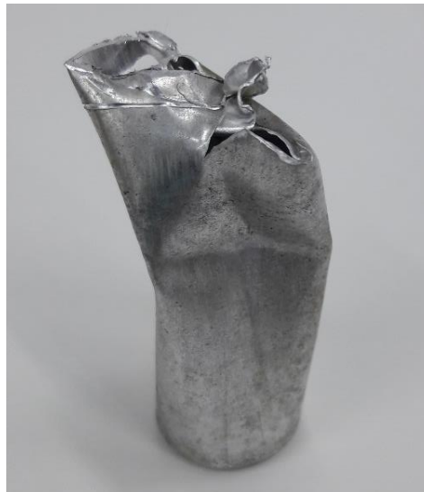
Figura 32 – Cápsula colapsada devido ao corte impreciso.
