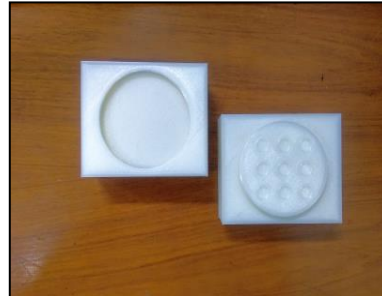
Figura 94: Acessório para posicionar os dosímetros \text{CaSO}_4:\text{Dy} , impresso em 3D com preenchimento 100% infill .
