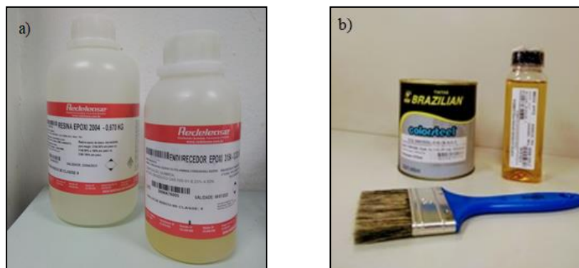
Figura 45: a) Resina epóxi, b) Tinta de coloração cinza, utilizada para finalização do objeto simulador.
