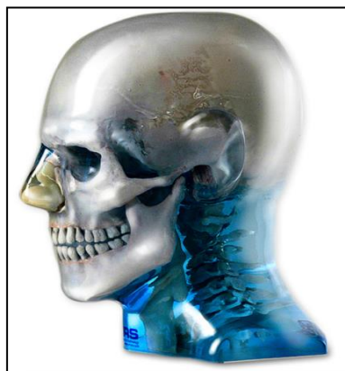
Figura 39: Simulador 711-HN da CIRS usado como referência para impressão do simulador impresso em 3D para dosimetria clínica de feixe de fótons.
