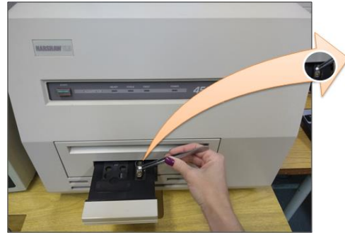
Figura 29: Leitora TL/OSL da marca RISO™, modelo TL/OSL-DA-20.
