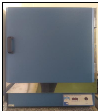
Figura 25: Estufa de secagem e esterelização, modelo SL-100.
