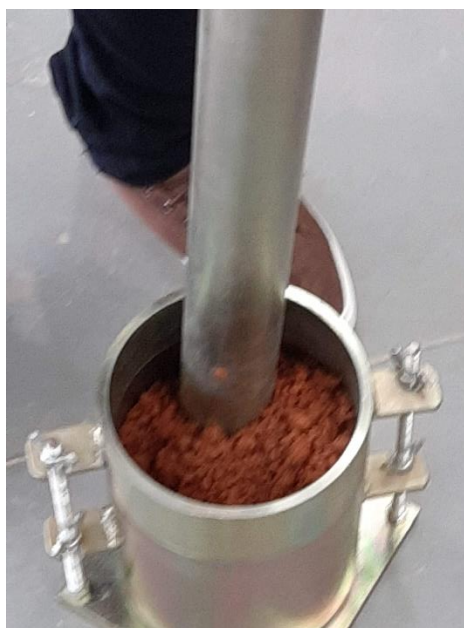
Figura 19: Compressão do material com o martetele.
