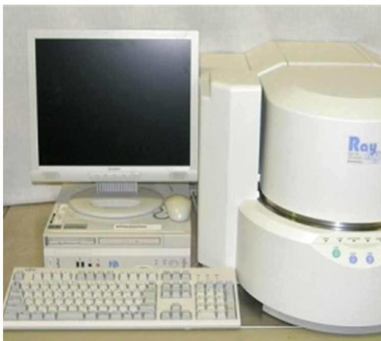
Figura 31. Equipamento de Fluorescência do raio X, modelo EDX-900HS da marca SHIMADZU.
