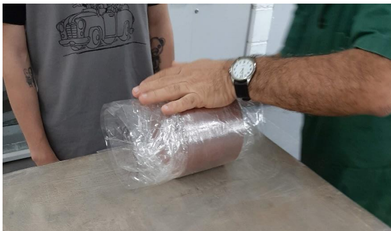
Figura 21: Embalagem dos corpos de prova .
