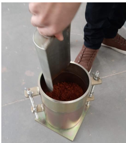
Figura 18: Foto ilustrativo da inserção do material na camisa.
