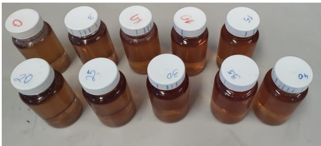
Figura 26: Solução Fricke Gel com alaranjado de xilenol acondicionadas em frascos PETE para medida de referência da tomografia computadorizada óptica.
