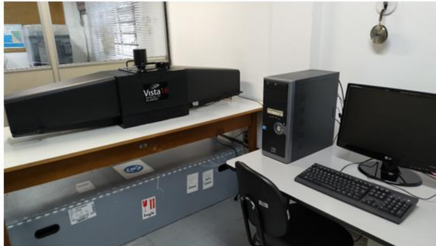
Figura 30: Aparelho de CT óptico VISTA16. (a) Equipamento instalado no Laboratório de Altas Doses. (b) Representação esquemática do interior do equipamento VISTA16
