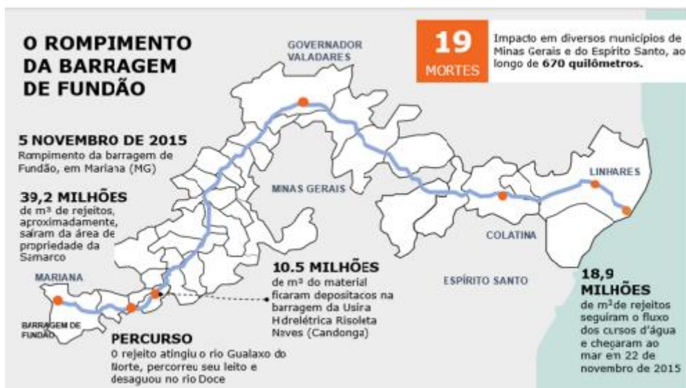
Fig. 2 – O ROMPIMENTO DA BARRAGEM DE Fundão. Fonte: Cartilha VimVer. Fundação Renova
