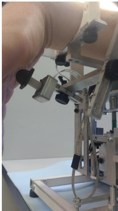
Figura 35: Ajuste do apoio do sensor de força, articulações A1 e A2.
