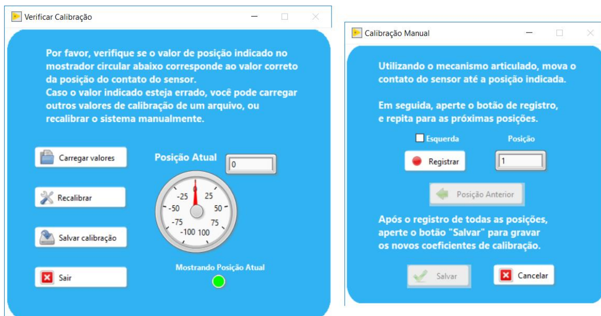
Figura 50: Tela de calibração (esquerda) e sub-tela de calibração manual (direita)
