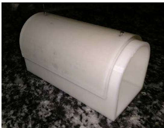
Figura 59 – Resultado do ensaio de Moldabilidade no quesito Caimento, para o material Aquaplast-T™
