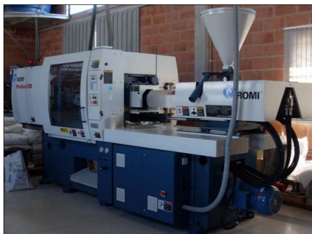
Figura 18 – Injetora, modelo Prática 130, ROMI
