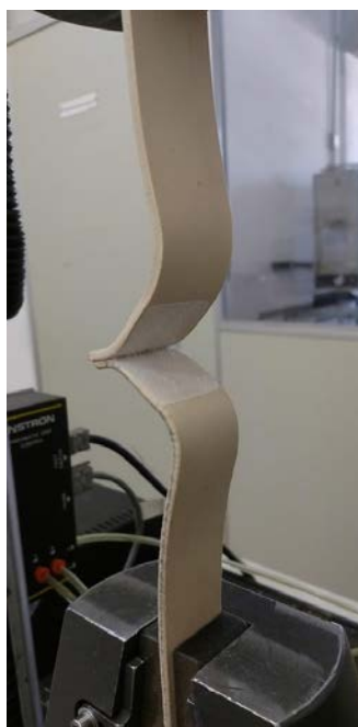
Figura 66 – Ensaio de Aderência com solicitação de tração, com o Material Ezeform™
