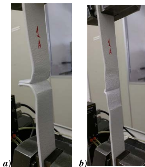
Figura 68 - Ensaio de Aderência com solicitação de tração, com o Material A em dois momentos: início (a) e final (b)
