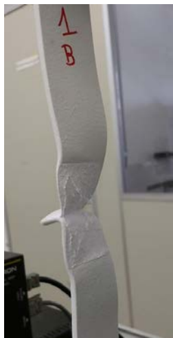
Figura 69 – Ensaio de Aderência com solicitação de tração, com o Material B
