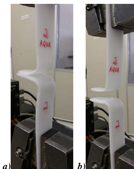
Figura 67 – Ensaio de Aderência com solicitação de tração, com o Material Aquaplast-T™, início do teste (a), destacamento repentino (b)
