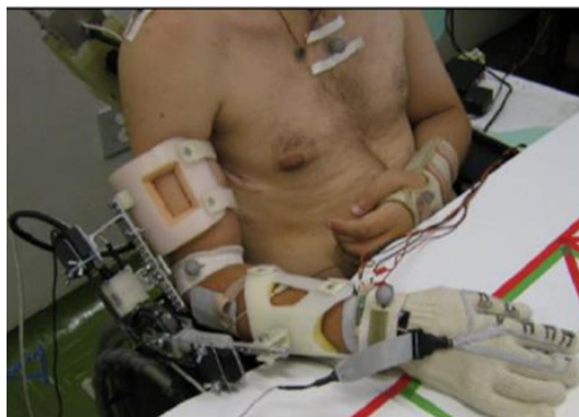
Figura 12. Órtese dinâmica para cotovelo com EENM.
