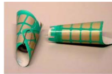
Figura 8. Tipos de eletrodos de superfície. (A) Eletrodos comerciais autoadesivos de superfície, (B) Eletrodos têxteis e (C) Eletrodos multipad.
