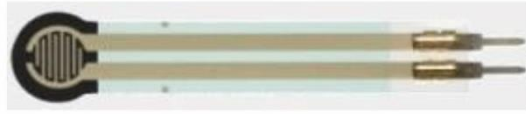
Figura 8. Sensor tátil 400 FRS Interlink®. Fonte: Adaptado de https://www.interlinkelectronics.com/fsr-400 . Acesso em 22 outubro de 2017
