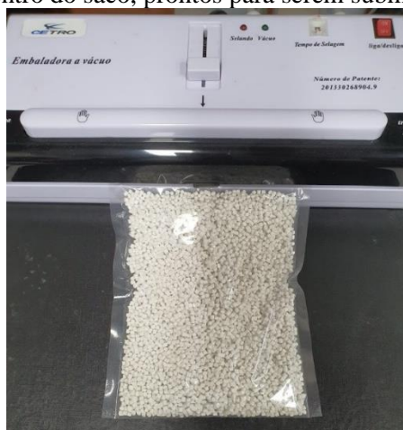
Figura 12 - Grânulos dentro do saco, prontos para serem submetidos à vácuo e selados.
