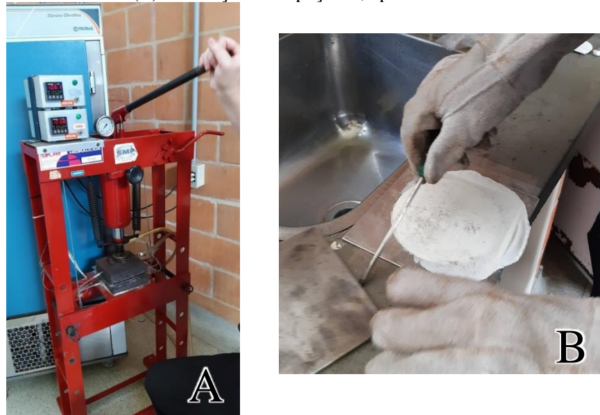
Figura 14 –prensagem do molde simples em prensa aquecida (A), iniciando a remoção das folhas de filme PET (B) e remoção do espaçador, após resfriamento.
