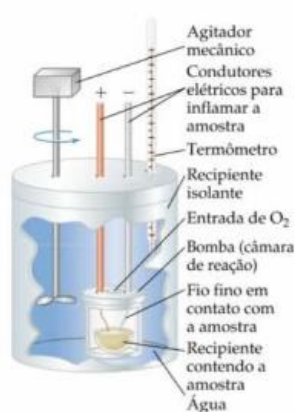
Figura 5.19 Vista em corte de uma bomba calorimétrica, na qual as reações ocorrem a volume constante.
