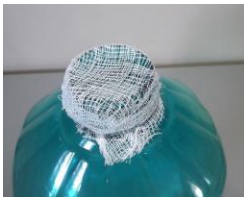
Imagem 1. Fixação do tecido com o elástico na boca da garrafa PET.
