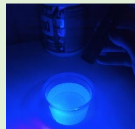
(B) Recipiente com água tônica sendo irradiado pela luz negra. Notamos o fenômeno de fluorescência
