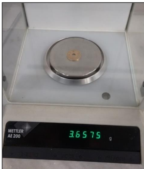
Figura 8. Medição da massa da moeda com uma balança analítica.
