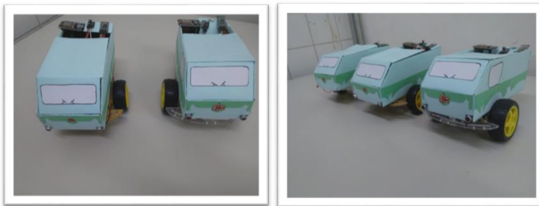
Figura 5 – Carrinhos robóticos construídos a partir do Arduino
