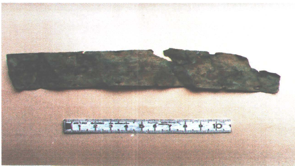
Foto 91 - Fita de estanho para remendar alguma peça com orifícios para rebite .
