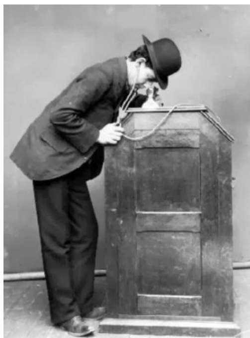
Figura 10 – O cinetoscópio de Thomas Edison, que depois foi aperfeiçoado pelos irmãos Lumière. A projeção das imagens era interna e só podia ser vista por uma pessoa de cada vez, tal como o peepshow proporcionado pelo estereoscópio e tantos outros dispositivos da época.
