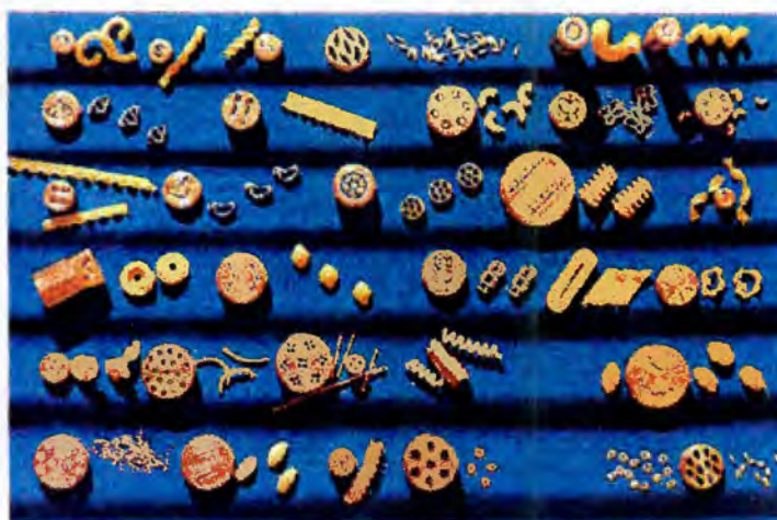
Trafile ed inserti per pasta lunga, corta e per formati speciali Fonte: catálogo eletrônico Landucci ( www.landucci.it )
